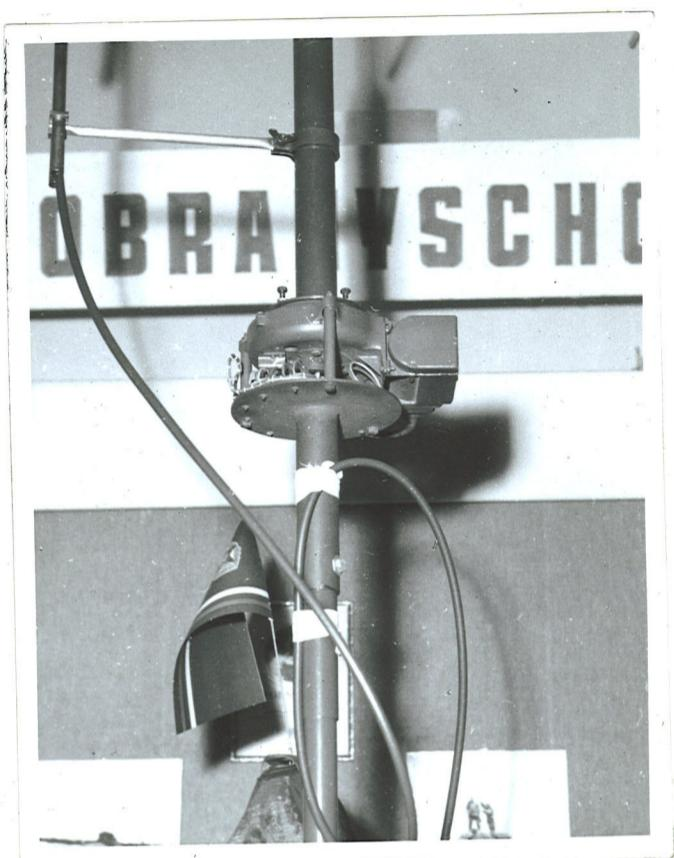
Elektricky ovládané směrování VKV antenního systému.
