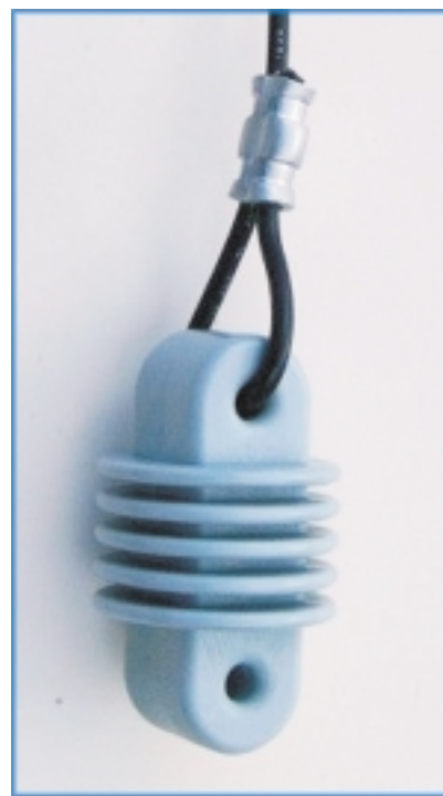
Obr. 2. Anténní i jiné izolátory jsou dnes předmětem sběratelského zájmu. Nicméně jsou stále důležitou součástí antén. Izolátorem na obrázku je opatřena sedmipásmová drátová anténa od firmy Buckmaster Antennas z Virginie
