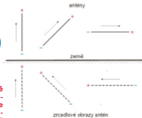
Obr. 1. „Zrcadlení“ lineárních antén nad rovinnou zemí
