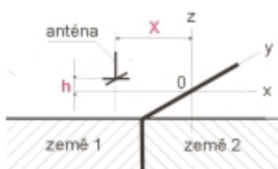
Obr. 1 a. Anténa je ve výšce h , popř. ještě ve vzdálenosti X od převážně rovného rozhraní dvou zemí (mořského či jezerního pobřeží, suché a mokré země apod.)
