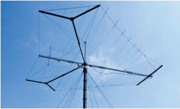
Obr. 4 a 5. LPD anténa fy Rohde&Schwarz, typ HL451 pro příjem od 2 do 30 MHz a pro vysílání od 5 do 30 MHz. „Zvlněním“ zkrácené drátové dipólové prvky, které podstatně zmenšují velikost antény, jsou izolovaně zavěšeny na nosné konstrukci. Zvlnění prvků je patrné na zvětšeném výřezu na obr. 5
