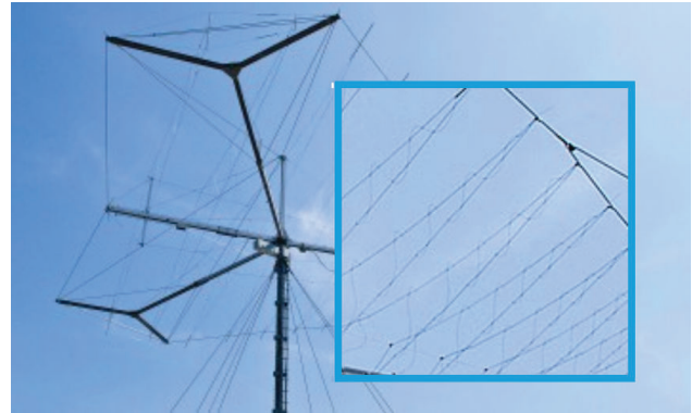
Obr. 4 a 5. LPD anténa fy Rohde&Schwarz, typ HL451 pro příjem od 2 do 30 MHz a pro vysílání od 5 do 30 MHz. „Zvlněním“ zkrácené drátové dipólové prvky, které podstatně zmenšují velikost antény, jsou izolovaně zavěšeny na nosné konstrukci. Zvlnění prvků je patrné na zvětšeném výřezu na obr. 5
