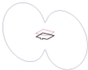
Obr. 1. Podél malé (čtvercové) smyčky se vř proud rozloží rovnoměrně, takže v rovině smyčky je záření všesměrové. Prostorový (3D) diagram záření má tvar prstence (anuloidu), jehož osa je totožná s osou malé smyčky
