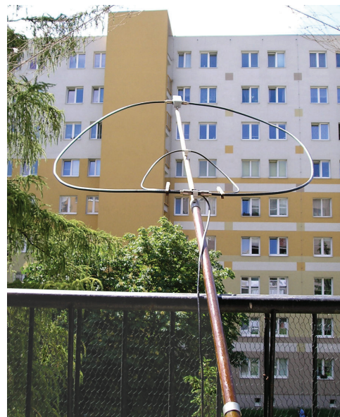
Obr. 3. Magnetická smyčková anténa pro 7 MHz (podle obr. 1c) z koax. kabelu 75 \Omega , 3/8 Penflex, resp. čs. ekvivalentu VCCZE 75-6,5 z (bývalého) Kablo Bratislava v instalační poloze
